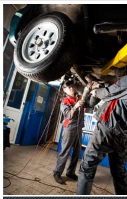
[2] Демонтируем старую выхлопную систему, срезая некоторые старые детали при условии закиших болтов, разделив выхлопную систему на три части.
